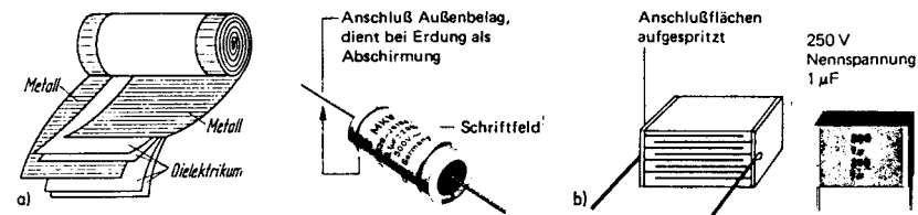
Aufbau und Kennzeichnung von Wickel- und Schichtkondensatoren
